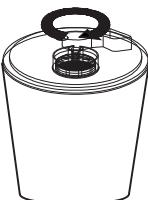
Setzen Sie den Wassertank wieder auf den Körper und die Düse oben auf den Wassertank.
