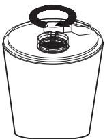
6. Mettez le réservoir d'eau sur la base. Fixez la buse sur le réservoir d'eau
