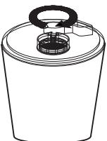
7. 水タンクを逆さにして位置を合わせて本体ベースにセットします。最後、蒸気ノズルを入れ直す。
