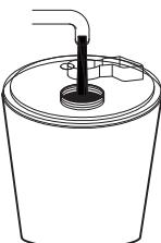
Drehen Sie die Kappe zu und setzen Sie den Filter ein. Entfernen Sie Wasserspritzer um den Wassertank herum.
